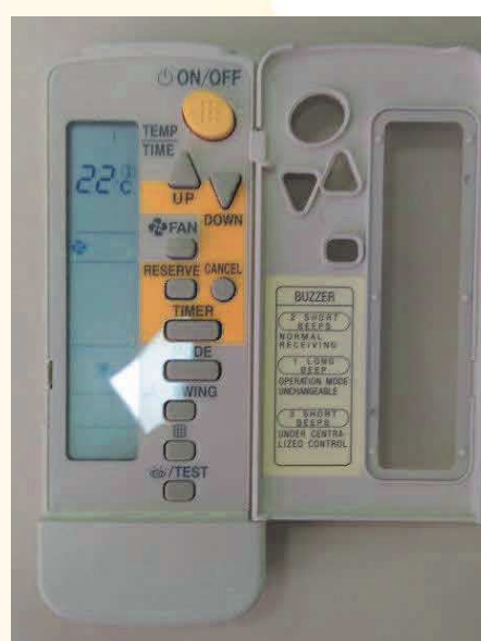
Foto 25: Isolamento térmico das unidades VRF (E); Foto 26: Controle individual das evaporadoras do VRF (D).
