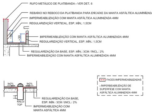
**DET. 2 - DETALHE GENÉRICO IMPERMEABILIZAÇÃO CALHA COM MANTA ASFÁLTICA ALUMINIZADA SEM ESCALA**
