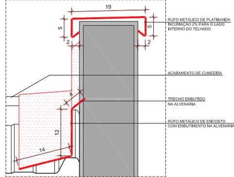
**DET. 5 - DETALHE GENÉRICO RUFU METÁLICO DE ENCOSTO - EMBUTIMENTO NA ALVENARIA 1:2**
