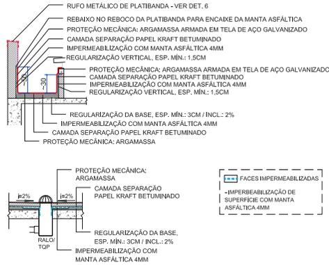
**DET. 1 - DETALHE GENÉRICO IMPERMEABILIZAÇÃO CALHA COM MANTA ASFÁLTICA SEM ESCALA**
