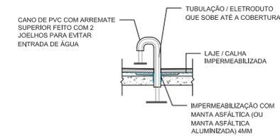
**DET. 3 - DETALHE PADRÃO IMPERMEABILIZAÇÃO - TUBULAÇÕES EMERGENTES SEM ESCALA**
