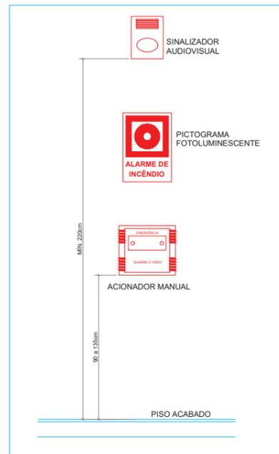
**DETALHE - ACIONADOR E SINALIZADOR ALARME DE INCÊNDIO**
