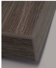
FITA DE BORDA EM ABS NO MESMO PADRÃO DO TAMPO, COLADA E ARREDONDADA COM TUPIA
