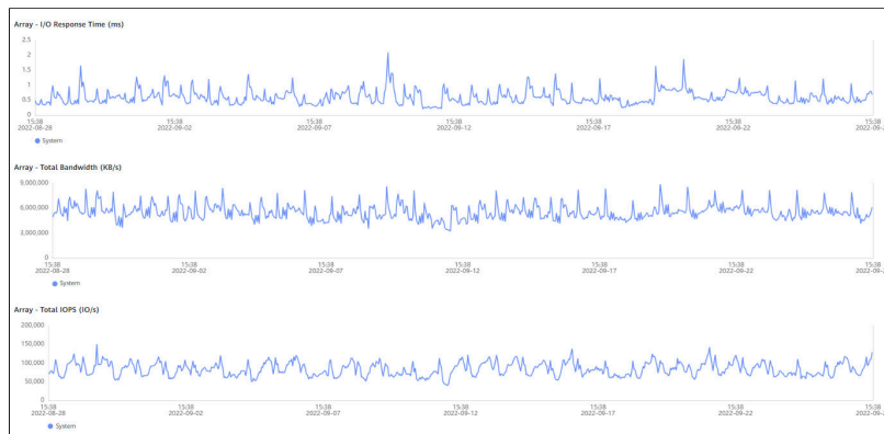
Figura 7: Tempo de Resposta (em ms), Throughput (em GBytes/s) e Números de Operações de Entrada e Saída (IOPS) em janelas de uma hora no período de um mês.
